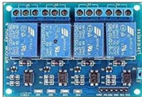
Fig. 3: Relay Module [9]
