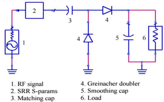
**FIGURE-4: RECTIFIER CIRCUIT**
